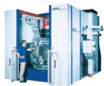
DEPO HC 1212—水平 3+2轴 龙门加工 加工范围1200x1200x800mm
