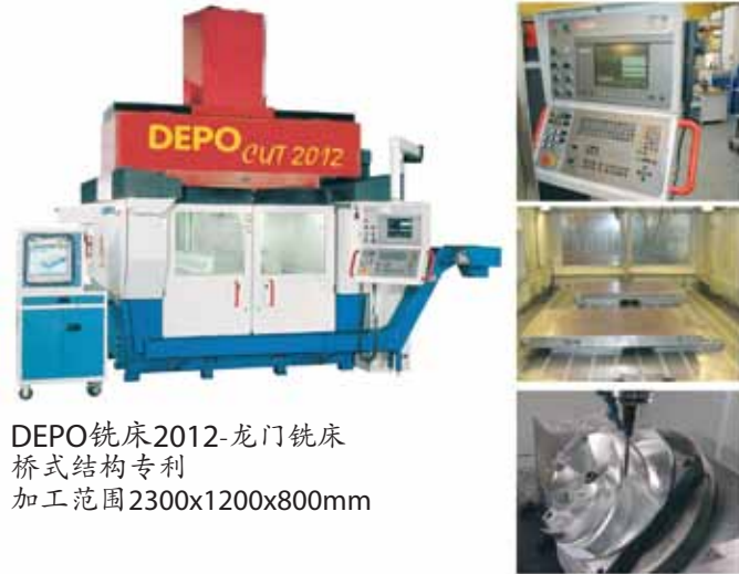
轴龙门加工 桥式结构专利 加工范围2300x1200x800mm
